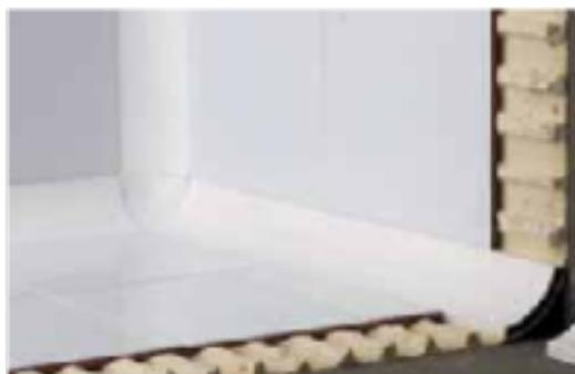
Escoria fabricada en aluminio, para colocación antes de obra. Su diseño facilita la limpieza de zonas difíciles y evita la acumulación de gérmenes y suciedad quedando integrada en la instalación durante los trabajos de alicatado. El perfil es reversible, pudiendo colocarse en ángulos interiores y también exteriores.
