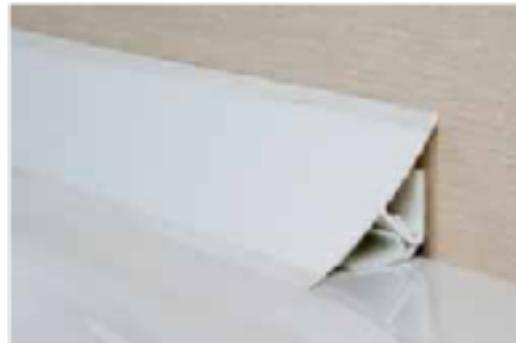
Escocia fabricada en dos piezas de PVC, para colocación después de obra, espacialmente en entornos con limpiezas agresivas. Su diseño facilita la limpieza de zonas difíciles y evita la acumulación de gérmenes y suciedad. La pieza exterior cuenta con dos labios de PVC blando para adaptarse a las irregularidades de la pared.
