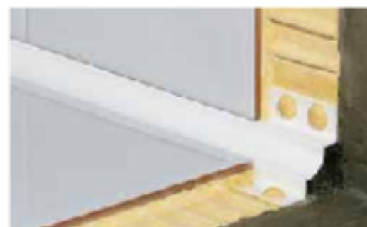
Escocia fabricada en aluminio o PVC, para colocación antes de obra. Su diseño facilita la limpieza de zonas difíciles y evita la acumulación de gérmenes y suciedad quedando integrada en la instalación durante los trabajos de alicatado.
